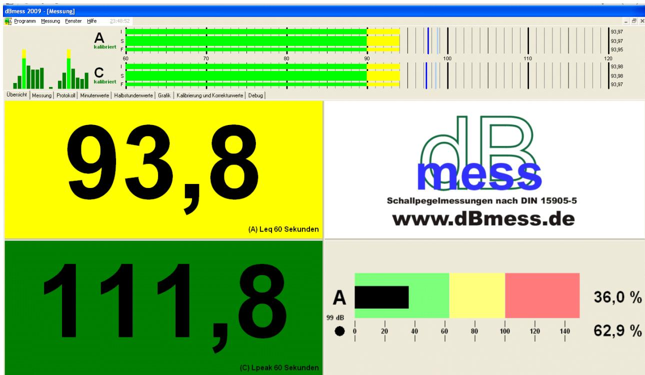
dBmess 2009 ist ein PC-gestütztes Schallpegelmess-System, das auf die Messungen in Veranstaltungsstätten, insbesondere auf die Anforderungen der DIN 15905-5 hin optimiert ist.
